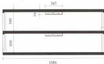
Die knappen Raumhöhen erforderten die Konstruktion eines niedrigen Technikkoffers.
