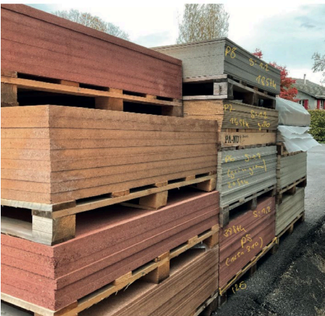
Ausschussware / Bauabfall: falsch gelagerte Eternit / Cemspan-Platten
