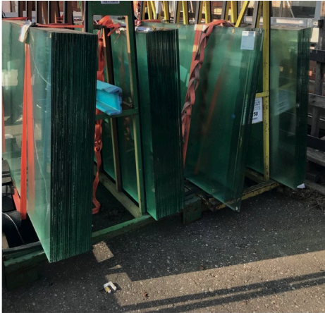
Ausschussware / Bauabfall: Glasscheiben VSG
