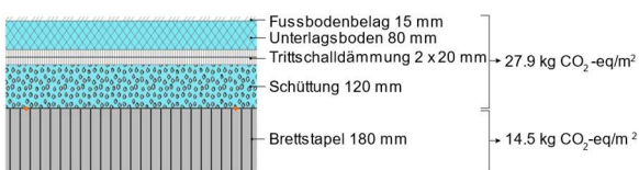
Abb. 4 Aufbau einer leichten Geschossdecke zur Gewährleistung der Trittschalldämmung [14]
