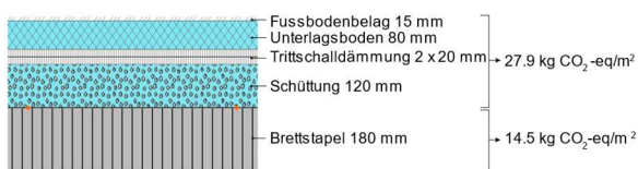
Abb. 4 Aufbau einer leichten Geschossdecke zur Gewährleistung der Trittschalldämmung [14]
