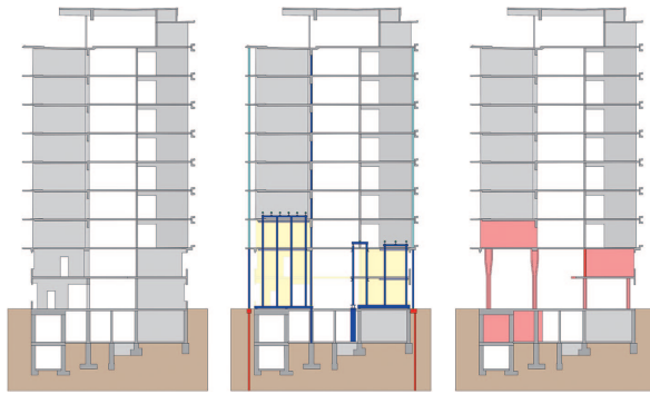
Fig. 10 Umbaukonzept Foyer: Bestand/Notspriessung und Abbruch/Neubau.
