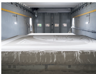
Fig. 6 Sandbett-3D-Druckanlage. 3D sand printer.
