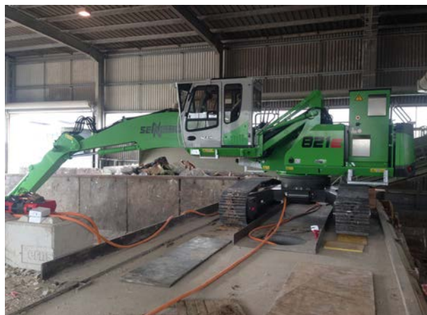
REWAG Entsorgung AG Kaiseraugst. Pelle électrique pour le tri des déchets de chantier.
