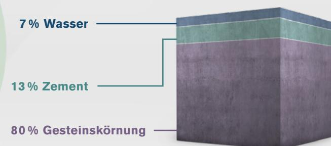
Von «Normalbeton» spricht man bei einem spezifischen Gewicht (Dichte) von  $2000 \text{ kg/m}^3$  bis maximal  $2600 \text{ kg/m}^3$ .
