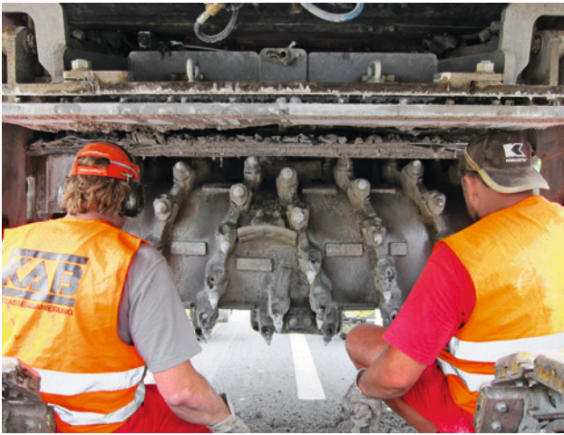
Abb. 2 Fräskopftausch bei der Fräse, Arbeitsbreite 2,2 m
