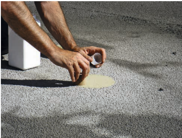
8. Contrôle de la profondeur de rugosité
