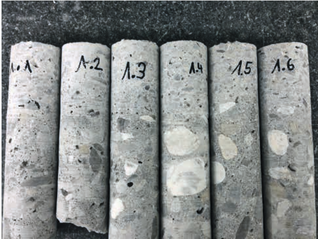
Carottes Ø 50mm extraites de la construction-test 1
