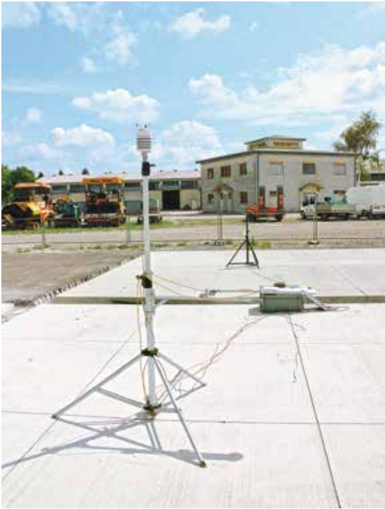
Illustration 11: Instrument de mesure servant à établir le bilan radiatif, la température atmosphérique, la vitesse et la direction du vent
