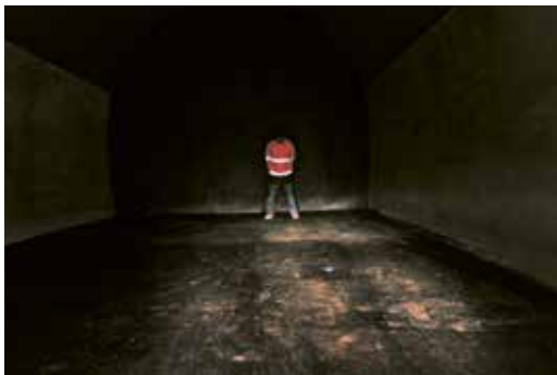
Abbildung 14: Ausleuchtung von Fahrbahnoberflächen bei vergleichbaren Gegebenheiten (Wand leicht verschmutzt, Decke gereinigt)
