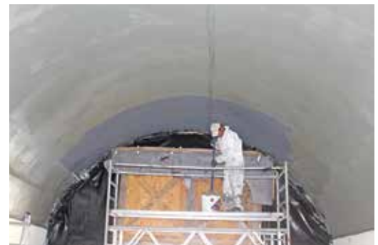
Abbildung 7: Herstellen der Beurteilungszustände im adaptierten Versuchstunnel
