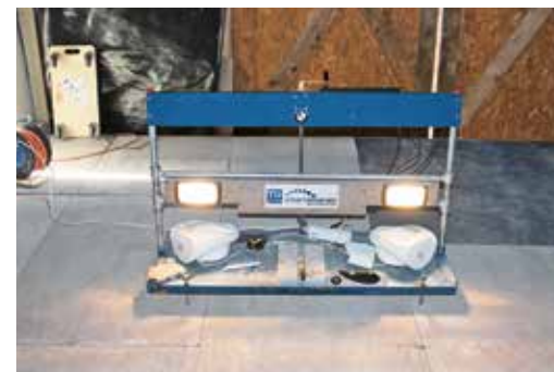
Illustration 9 : mesure de l'analyse de la visibilité d'objets dans le tunnel grâce à différentes surfaces
