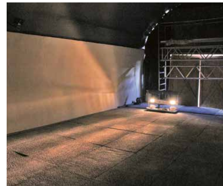
Illustration 9 : mesure de l'analyse de la visibilité d'objets dans le tunnel grâce à différentes surfaces
