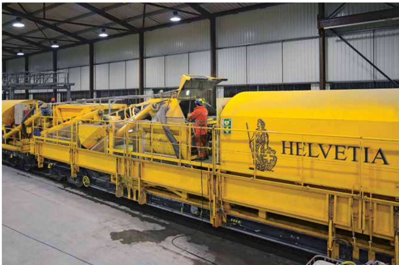
Illustration 16 : le train de bétonnage dans la halle — site de transbordement des matériaux et atelier de maintenance © TTG
