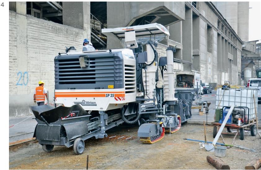
Illustration 3 : gestion du trafic sur une voie Illustration 4 : finisseur à coffrage glissant
