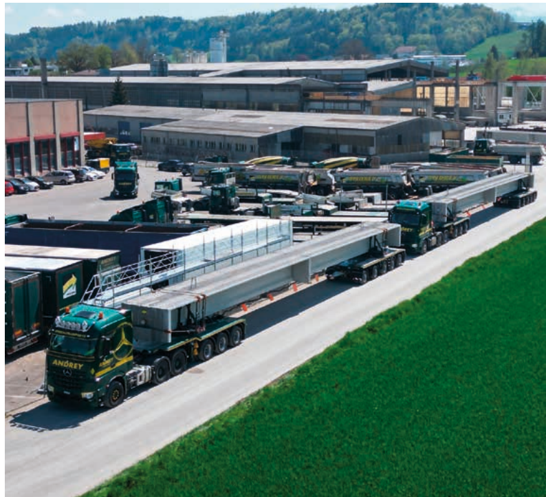
Der Transport der Spezialträger (70 Tonnen) mit dem Schwerlasttransporter auf der Baustelle erforderte Fingerspitzengefühl und Professionalität von allen Beteiligten. Bild: leistungsfotografie.ch
