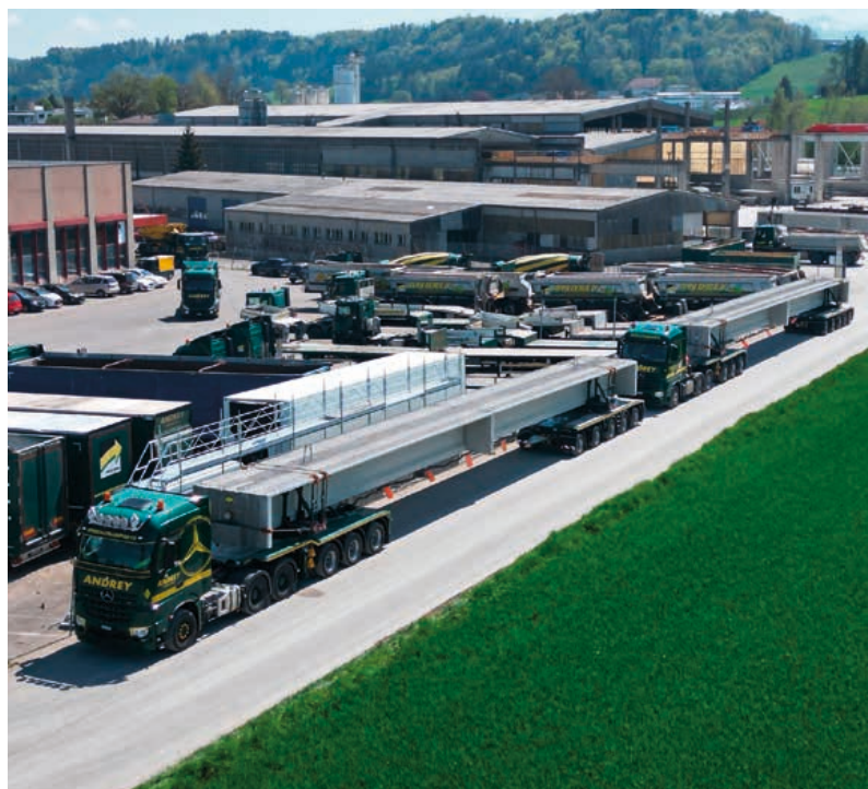
Le transport des travées spéciales (70 tonnes) sur le chantier par convoi exceptionnel a exigé du doigté et du professionnalisme de la part de tous les intervenants. Photo : leistungsfotografie.ch
