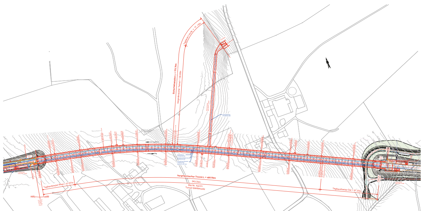
Schéma du tunnel de Städtlerwald avec galerie de sécurité reliée à angle droit. Schéma : IG UCH Cham+
